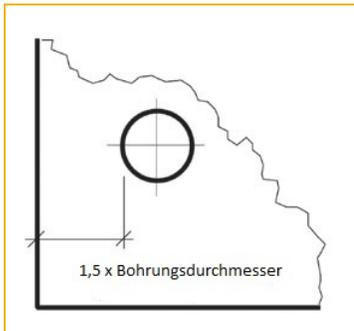
Bei einer punktuellen Befestigung sind die Bohrlöcher ausreichend zu dimensionieren, um auch bei dieser Art der Befestigung ein **Dehnungsspiel von 5 mm/m** Plattenlänge aufnehmen zu können. Als Plattenlänge gilt hier der Abstand der beiden Bohrungen, die am weitesten auseinander liegen.
